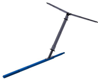
图4 风洞试验模型骨架梁模型
