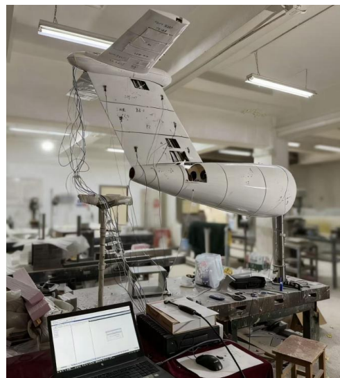
图8 风洞试验模型地面共振试验
